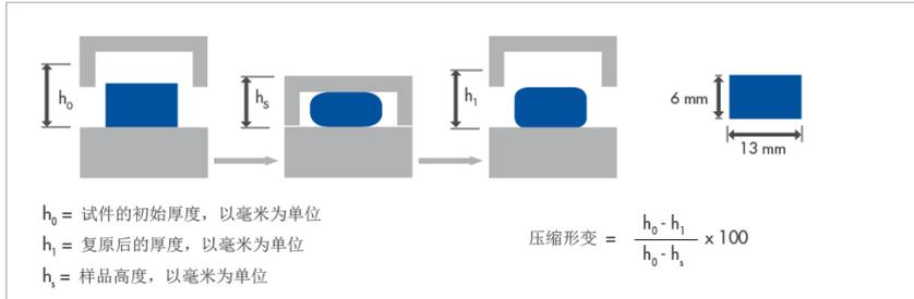
将样品压缩 25%。将压缩后的样品加热至测试温度。
